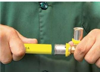
Inserire con un'adeguata pressione il tubo nel raccordo verificando il corretto posizionamento mediante i 3 fori presenti sul bussolotto in acciaio
